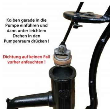
Füllen Sie vor dem ersten Gebrauch durch die Kolbenstangen-Öffnung im Pumpendeckel ca. 1 Liter Wasser ein, um die Pumpen in Gang zu bringen. Bei längerem Nichtgebrauch der Pumpe kann es notwendig sein, erneut Wasser einzufüllen.
