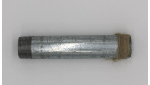
Bild 2 Umwickeln der Gewinde mit Hanf
